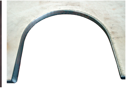
연속개선절단 (Continuous Bevel Cutting)
